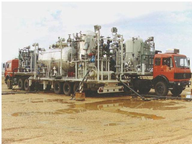
طراحی چهار مجموعه از تسبیلات فرآورش سیار نفت به منظور چلوگیری از آلودگی محیط زیست ناشی از سوزاندن نفت چاهها به دلیل عملیات اسید زنی و یا تعمیر آن و ۲ دستگاه نمکزدایی سیار
